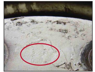
Si des roues avec une épaisseur excessive de peinture, des débris ou une corrosion excessive sont installées, la peinture, les débris et la corrosion sortiront graduellement durant l'opération.
