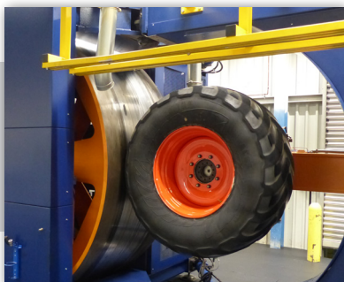
Abrollprüfstand für Radial-Ermüdungsprüfung großer OHW-Räder
