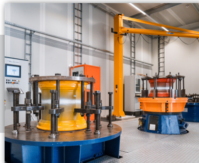
Cornering Fatigue Test Rigs
