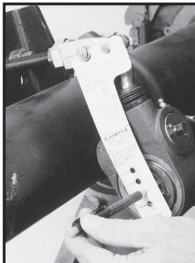
7. Une fois que le jeu est correctement ajusté, serrez l'écrou de blocage de 1-1/4" sur la chape à un couple de 40 à 50 pi.lb.
