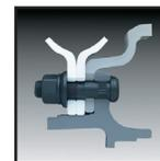
Sección transversal típica de un montaje plano dual. (Usa únicamente tuercas de rosca derecha)
