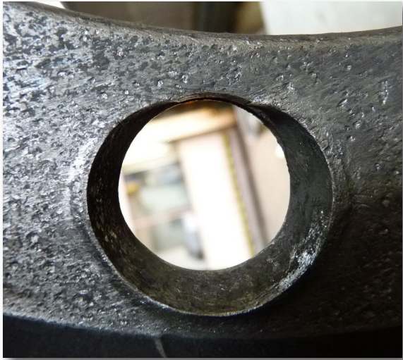
Stud hole deformation
