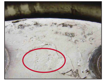
Signes visible que la peinture excède l'épaisseur maximum permise de 3,5 mils. Des couches multiples, une surface inégale et un estampillage illisible indiquent qu'il y a trop de peinture.
