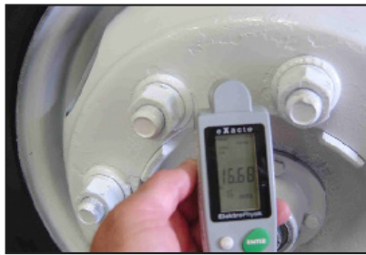
La jauge d'épaisseur de peinture donne 16,68 mils, au-dessus du maximum permis de 3,5 mils.
