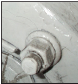
Signes visible que la peinture excède l'épaisseur maximum permise de 3,5 mils. Des couches multiples, une surface inégale et un estampillage illisible indiquent qu'il y a trop de peinture.
