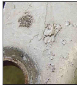
Signes visible que la peinture excède l'épaisseur maximum permise de 3,5 mils. Des couches multiples, une surface inégale et un estampillage illisible indiquent qu'il y a trop de peinture.
