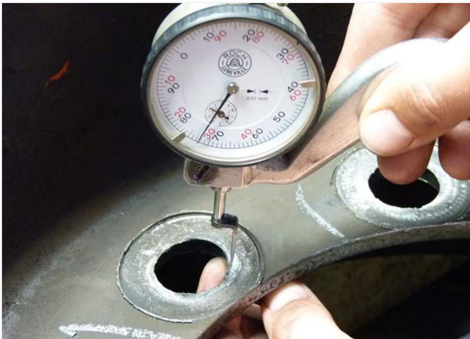
Dickenprüfung der Mutter-Kontaktfläche Nut contact area thickness check Vérification de l'épaisseur dans la zone de contact écrou
