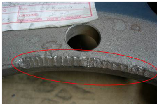
Verdrehung des Rades auf der Montagemaschine Rotation of the wheel on the mounting machine Rotation de la roue sur la machine de montage
