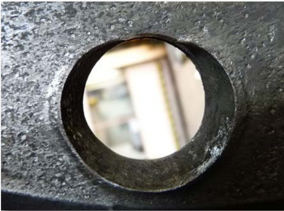
Bolzenloch Verformung Stud hole deformation Déformation du trou d'attache
