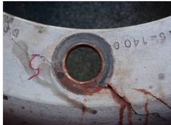
Radschüssel Risse am Bolzenloch Wheel disc cracks at stud hole Casse du disque aux trous d'attache
