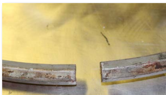
Spalt zwischen den Enden des Verschlussringes - Verschlussring ist zu verschrotten Gap between locking ring ends - Locking ring to be scrapped Jeu entre les extrémités de l'anneau de verrouillage - anneau de verrouillage à cafuter
