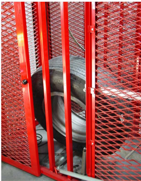
Aufpumpen im Sicherheitskäfig Inflation in safety cage Cage de gonflage
