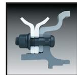
Sección transversal típica de un montaje plano dual. (Usa únicamente tuercas de rosca derecha)
