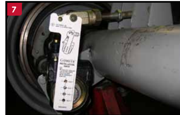
7 Después de apretar la tuerca de 1/4" a la horquilla, asegúrese que la rosca de la espiga este completamente enroscada en la tuerca hexagonal de 3/4".
