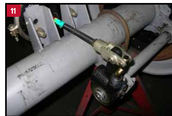
11 Aplique los frenos a fondo y suelte el pedal, permitiendo a la varilla de la cámara de freno, que viaje hasta su máxima carrera.
