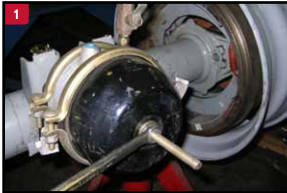
1 Si el eje cuenta con este tipo de frenos de aire, bloquee manualmente, los frenos, siguiendo las recomendaciones del fabricante.
