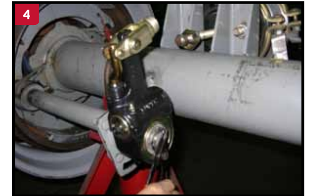
4 Instale el Ajustador usando al menos una roldana interior, para alinear el Ajustador con la espiga de la cámara de freno y coloque roldanas exteriores, solo las suficientes, para que el Ajustador no se mueva a más de 0.060", una vez instalado. Asegure el ensamble con el Seguro.
