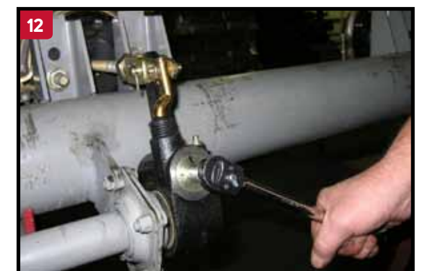
12 Ajuste los frenos girando el ajustador hexagonal, de acuerdo a las manecillas del reloj, hasta que las balatas, toquen el tambor. Regrese el Ajustador, girando la ajustador hexagonal, 1/2 vuelta, al contrario de las manecillas del reloj, lo anterior requiere, de 30 a 50 lbs./pie de torque. Escuchara un sonido como de "matraca", cuando regrese el ajustador. Al completar este paso, desbloquee los frenos ver el cuadro No. 1.
