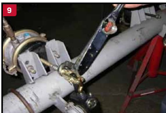
9 Usando un torquímetro, apriete la tuerca de 1/4" a la horquilla, con un torque de 40 a 50 lbs./pie, posteriormente, apriete la tuerca de 15/16", vs el seguro de tuerca, con el mismo torque, 40 a 50 lbs./pie.
