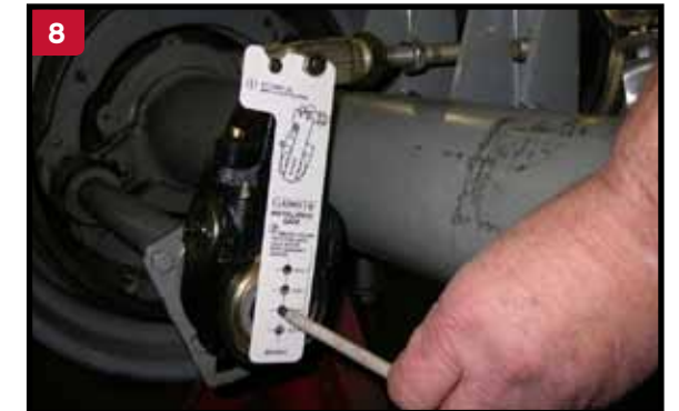
8 Alinee el ajustador, apretando la tuerca de 3/4" de la espiga, hasta que el correspondiente agujero de la plantilla, quede alineado con el agujero central del engrane del ajustador, como se muestra arriba.
