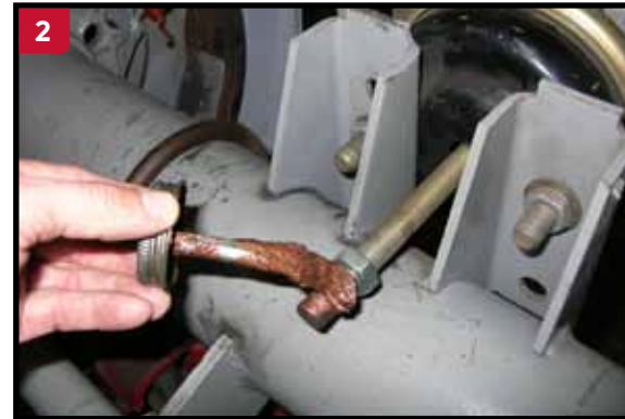
2 Aplique antiadherente a los roscas de las varillas de la cámara de frenos, antes de instalar horquillas nuevas.
