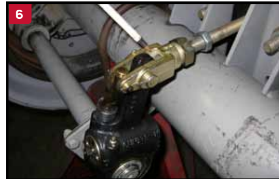
6 Antes de colocar la tuerca de 1/4" a la horquilla, asegúrese que la rosca de la espiga este completamente enroscada en la tuerca hexagonal de 3/4". La espiga puede extenderse hasta 1/16", después de la horquilla. Si se extiende más de 1/16", después de la horquilla, deberá cortar el vástago.
