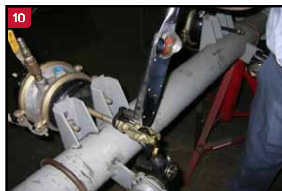
10 Una vez que la tuerca ha sido apretada a la horquilla, apriete la tuerca 15/16", contra el tuerca de seguro con un torque de 40 a 50 lbs./pie.
