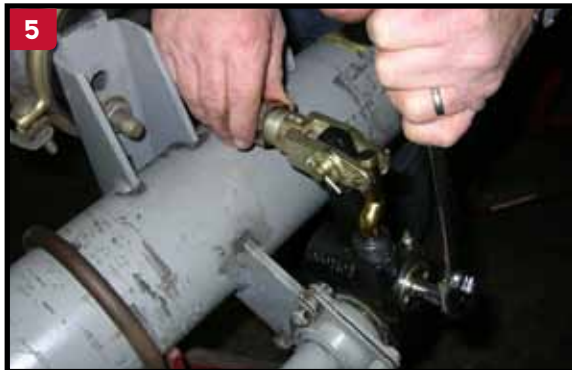
5 Usando una llave, apriete el ajustador con la tuerca y alinee la rosca con la horquilla.
